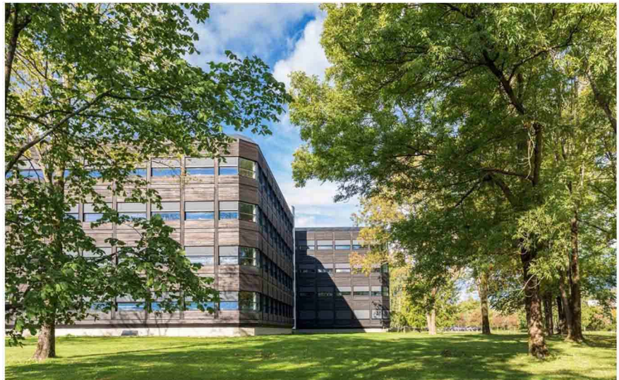
Powerhouse Kjørbo i Sandvika er Norges første energipositive kontorbygg, og trolig verdens første rehabilitert til plusshusnivå. Etter reoveringen ble energibehovet redusert med mer enn 86 prosent. Foto: Aadland
